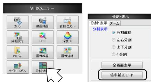
「倍率補正モード」が青くなり、観察ウィンドウに補正後画面が表示されます。
