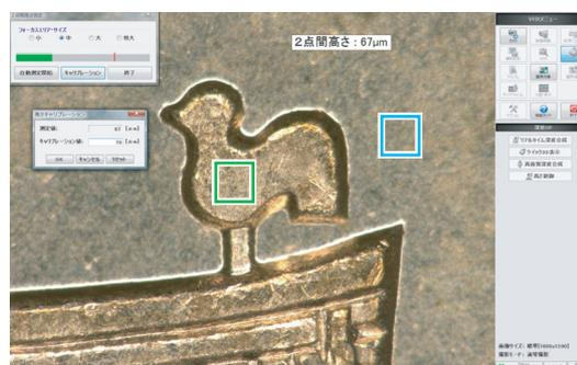
「高さキャリブレーション」ダイアログボックスが表示されます。
