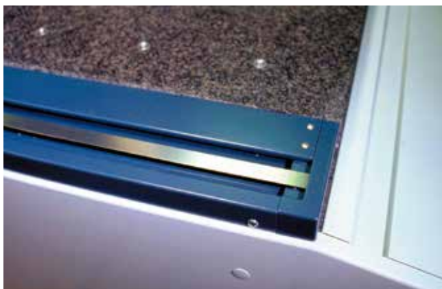
Y軸左側ガイドの保護カバー
