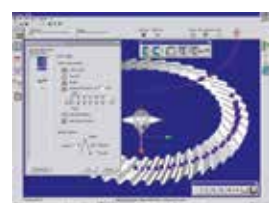
埋込式ロータリテーブルRT1によるほぼ歯車測定
