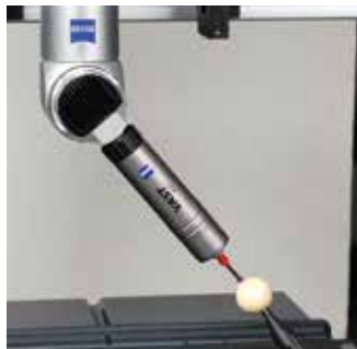
VAST XXXT スキャニング測定センサ サンプリング点数: 150 点 / 秒 スタイラス長さ: Max150 mm (TL3)
