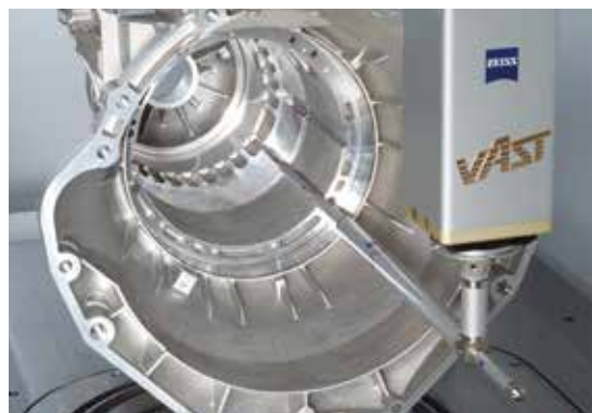
スタイラス長さ 600 mm によるスキャニング測定
