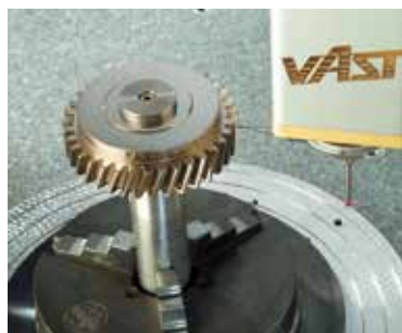
埋込式ロータリテーブルRT1によるほぼ歯車測定
